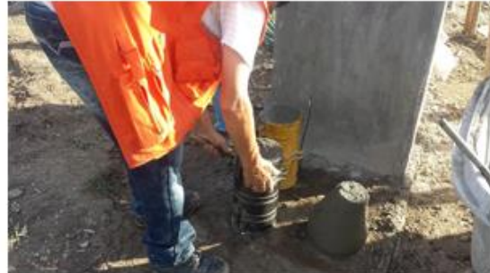
Foto 4: Muestras de cilindros de concreto para ensayos de resistencia
